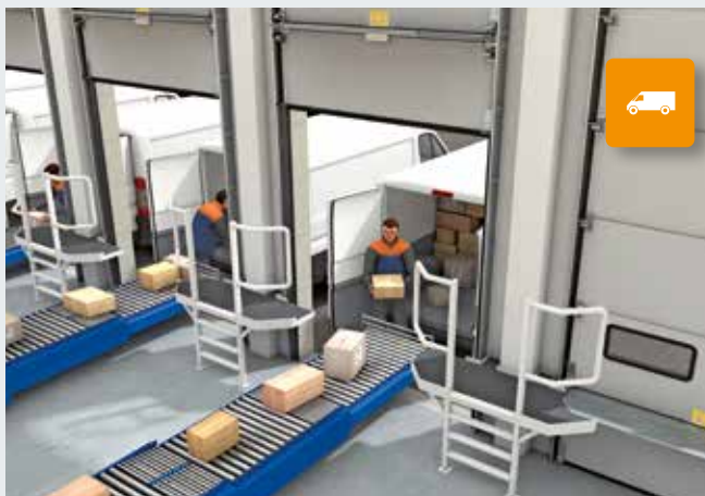
I furgoni vengono caricati allo stesso livello del pavimento del capannone. Il portone si apre completamente, solidale col segmento inferiore
